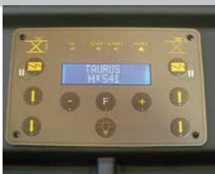
**1** L'elettronica di controllo è dotata di un display alfanumerico con numerose funzioni per l'utente, fra cui la possibilità di visualizzare l'altezza del ponte e impostare l'arresto del sollevatore all'altezza desiderata.
