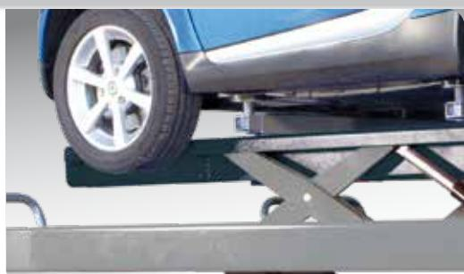
**2** TABLE ELEVATRICE innovante, en mesure de soulever tout type de véhicule et d'une **portée de 5 000 kg, comme le pont-élévateur principal**.
