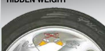
Parfaite esthétique de la jante parce qu'elle permet de diviser la masse d'équilibrage adhésive du flanc extérieur en deux masses équivalentes placées dans une position cachée derrière les rayons.
