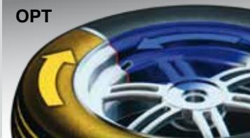
Programme identifiant la position de montage idéale entre la jante et le pneu afin de réduire le déséquilibre global de la roue.
