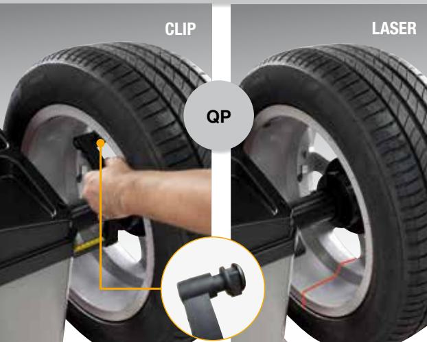
**Acquisition électronique** de la distance et du diamètre des roues jusqu'à 26" avec **fonction QP- Quick Program** intégrée qui active automatiquement les programmes d'équilibrage en évitant les sélections depuis le clavier. La machine fonctionne sur la base des préférences de l'opérateur. Le positionnement des contre-poids autocollants peut être réalisé selon **trois modes différents**:
