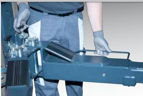
El sistema de **bloqueo automático de la rotación de los brazos** interviene en cuanto comienza la operación de subida, pero puede desbloquearlo el operario si es necesario accionando los correspondientes mandos situados en el pivote de rotación.
